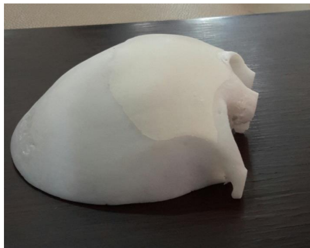
ตัวอย่างวัสดุฝังในบริเวณกะโหลกศีรษะและใบหน้าเฉพาะบุคคล ชนิดวัสดุ Silicone
